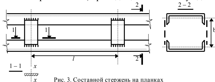
Рис. 3. Составной стержень на планках
